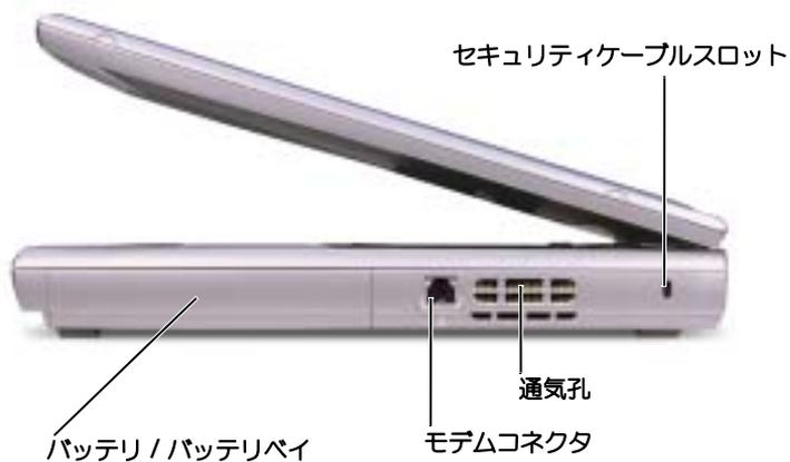
**バッテリー / バッテリーベイ** — バッテリーを取り付けると、コンピュータをコンセントに接続しなくてもコンピュータを使うことができます。41 ページを参照してください。
