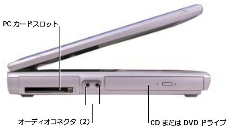
**PC カードスロット** — モデムまたはネットワークアダプタなどの PC カードを 1 枚サポートします。詳細については、『はじめよう』ヘルプファイルにある「PC カードの使い方」を参照してください。ヘルプファイルにアクセスするには、76 ページを参照してください。
