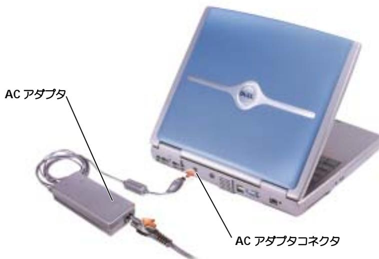
AC アダプタは AC 電力をコンピュータに必要な DC 電力へと変換します。AC アダプタは、コンピュータの電源のオンまたはオフにかかわらず接続できます。
