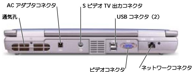
**通気孔** — コンピュータは内蔵ファンを使って、通気孔から空気が流れるようにします。これによって、コンピュータが過熱することを防ぎます。
