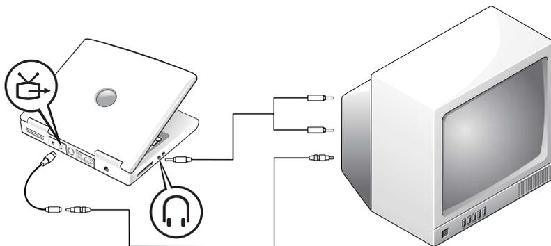
コンピュータをコンポジットビデオ入力専用のテレビに接続するには、コンポジット TV 出カアダプタケーブルを使用します。
