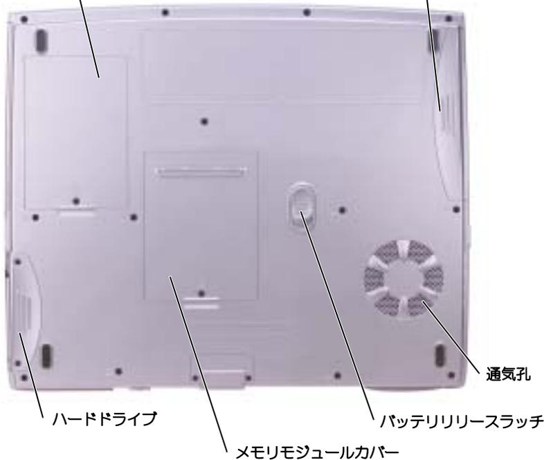
**モデム / ミニ PCI カードカバー** — モデムとミニ PCI カードのコンパートメントのカバーです。97 ページを参照してください。
